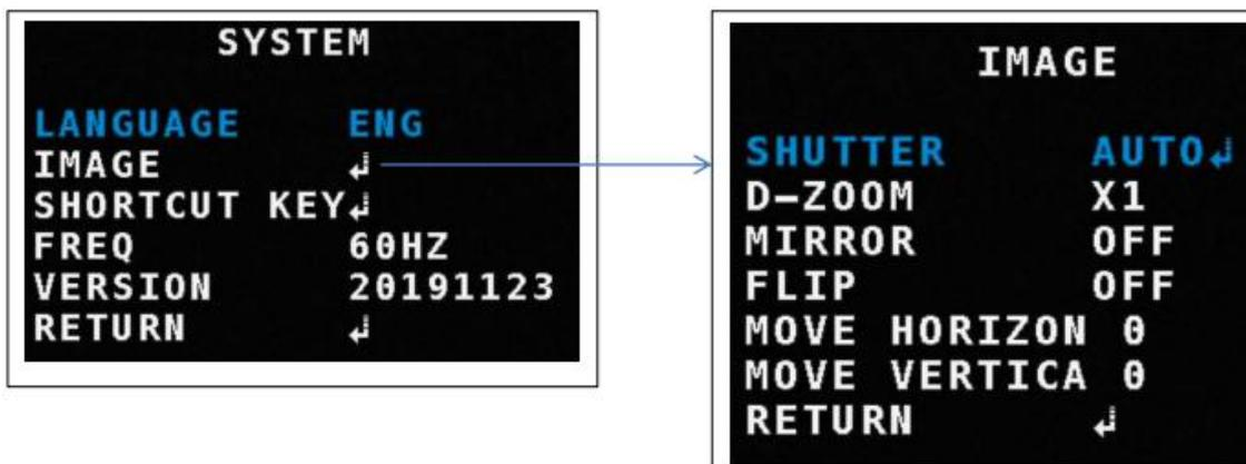
Mova o menu para "SYSTEM" e pressione a tecla "SET" no painel frontal para abrir a interface de configurações do sistema.
